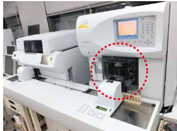
赤い枠部分に検体（血液）をいれ、測定します
