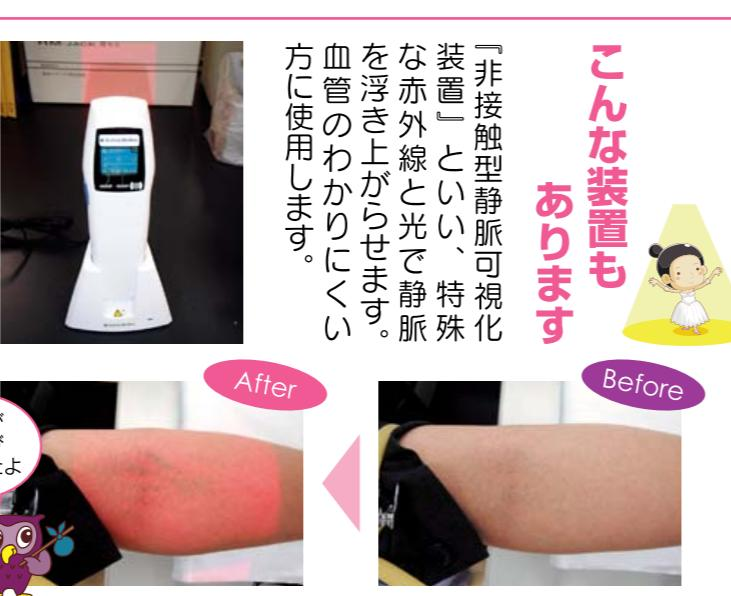
『非接触型静脈可視化装置』といい、特殊な赤外線と光で静脈を浮き上がらせます。血管のわかりにくく方に使用します。
