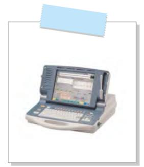
写真2: ペースメーカーの状況確認や設定変更に用いる装置。
