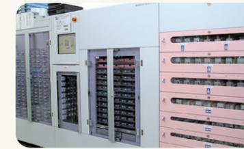
注射薬は形がよく似ており、取り間違いを起こしやすいので、当薬剤部ではアンプルピッカーという大きな機械を用いて、患者さんの注射薬の取り揃えを行っています。また、病棟から使用されずに戻ってきた薬も自動で仕分けすることができる最新のモデルを採用しています。
