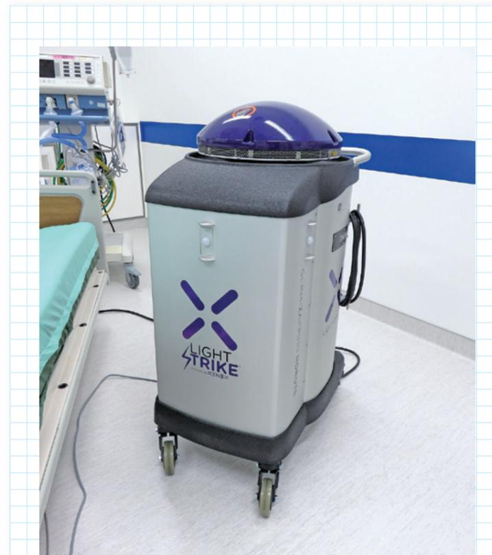
パルス方式キセノン紫外線照射ロボット
