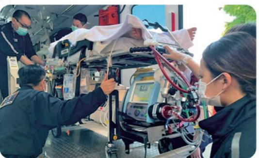
ドクターカーには、ECMO（エクモ）や人工呼吸器、その他の重症患者治療機器を搭載可能な専用のストレッチャーや、十分な電力、専門的資器材を搭載しています。
