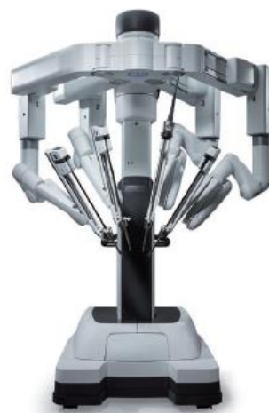
② ペイシェントカート
